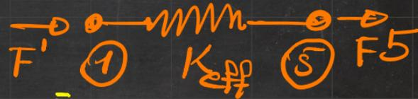
$$\begin{bmatrix} F^1 \\ F^2 \\ F^3 \\ F^4 \\ F^5 \end{bmatrix} = \underbrace{\begin{bmatrix} k^{11} & k^{12} & k^{13} & k^{14} & k^{15} \\ k^{21} & k^{22} & k^{23} & - & - \\ k^{31} & - & - & - & - \\ k^{41} & - & - & - & - \\ k^{51} & - & - & - & k^{55} \end{bmatrix}}_{K} \begin{bmatrix} u^1 \\ u^2 \\ u^3 \\ u^4 \\ u^5 \end{bmatrix} \Rightarrow F = K \cdot u$$
