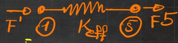
$$\begin{bmatrix} F^1 \\ F^5 \end{bmatrix} = \begin{bmatrix} 0.5 & -0.5 \\ -0.5 & 0.5 \end{bmatrix} \begin{bmatrix} u^1 \\ u^5 \end{bmatrix}$$
