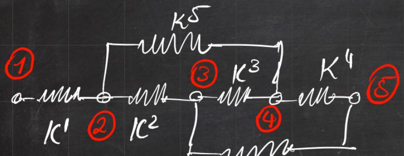
$$\begin{bmatrix} F^1 \\ F^2 \\ F^3 \\ F^4 \\ F^5 \end{bmatrix} = \underbrace{\begin{bmatrix} K^{11} & K^{12} & K^{13} & K^{14} & K^{15} \\ K^{21} & K^{22} & K^{23} & - & - \\ K^{31} & - & - & - & - \\ K^{41} & - & - & - & - \\ K^{51} & - & - & - & K^{55} \end{bmatrix}}_{\mathbf{K}} \begin{bmatrix} u^1 \\ u^2 \\ u^3 \\ u^4 \\ u^5 \end{bmatrix} \Rightarrow \mathbf{F} = \mathbf{K} \cdot \mathbf{u}$$
