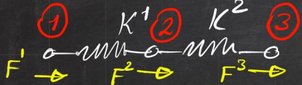
$$\begin{bmatrix} F^1 \\ F^2 \\ F^3 \end{bmatrix} = \begin{bmatrix} K^1 & -K^1 & 0 \\ -K^1 & K^1 + K^2 & -K^2 \\ 0 & -K^2 & K^2 \end{bmatrix} \begin{bmatrix} u^1 \\ u^2 \\ u^3 \end{bmatrix}$$
