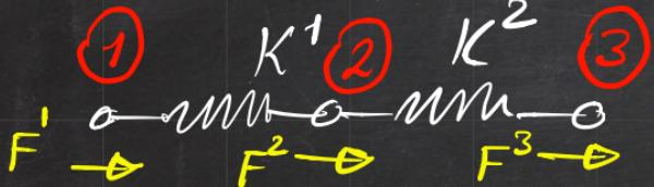
$$\begin{bmatrix} F' \\ F^2 \\ F^3 \end{bmatrix} = \begin{bmatrix} K' & -K' & 0 \\ -K' & K + K^2 & -K^2 \\ 0 & -K^2 & K^2 \end{bmatrix} \begin{bmatrix} u' \\ u^2 \\ u^3 \end{bmatrix}$$
