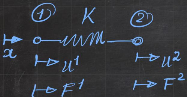
$$\begin{bmatrix} F^1 \\ F^2 \end{bmatrix} = \begin{bmatrix} K & -K \\ -K & K \end{bmatrix} \begin{bmatrix} u^1 \\ u^2 \end{bmatrix}$$
