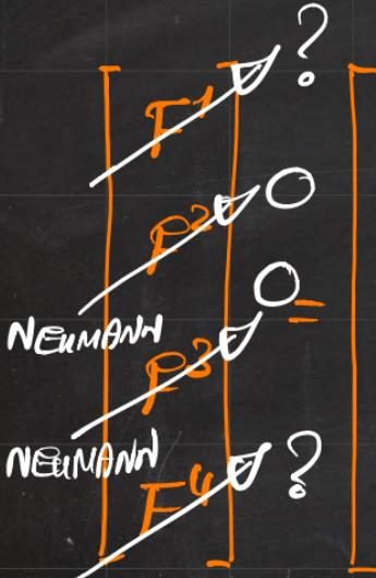
$$\begin{bmatrix} F^P \\ F^u \end{bmatrix} = \begin{bmatrix} K^{11} & K^{12} & K^{13} & K^{14} \\ K^{21} & K^{22} & K^{23} & K^{24} \\ K^{31} & K^{32} & K^{33} & K^{34} \\ K^{41} & K^{42} & K^{43} & K^{44} \end{bmatrix} \begin{bmatrix} u^1 \\ u^2 \\ u^3 \\ u^4 \end{bmatrix}$$
