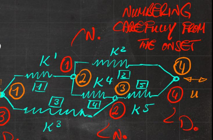
$$\begin{bmatrix} F^P \\ F^u \end{bmatrix} = \begin{bmatrix} K^{Pu} & K^{PP} \\ K^{uu} & K^{uP} \end{bmatrix} \begin{bmatrix} u \\ u^P \end{bmatrix}$$
