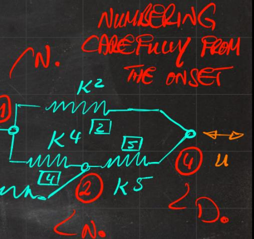
$$\begin{bmatrix} F^P \\ F^u \end{bmatrix} = \begin{bmatrix} K^{Pu} & K^{PP} \\ K^{uu} & K^{uP} \end{bmatrix} \begin{bmatrix} u^P \\ u^u \end{bmatrix}$$
