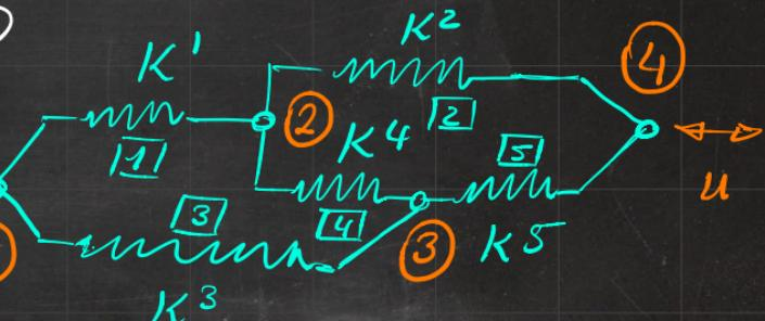
$$\begin{bmatrix} F^P \\ F^u \end{bmatrix} = \begin{bmatrix} K^{Pu} & K^{Pp} \\ K^{uU} & K^{uP} \end{bmatrix} \begin{bmatrix} u \\ u^P \end{bmatrix} \quad \begin{array}{l} \{ \text{No.} \\ \{ \text{D.o.} \end{array}$$
