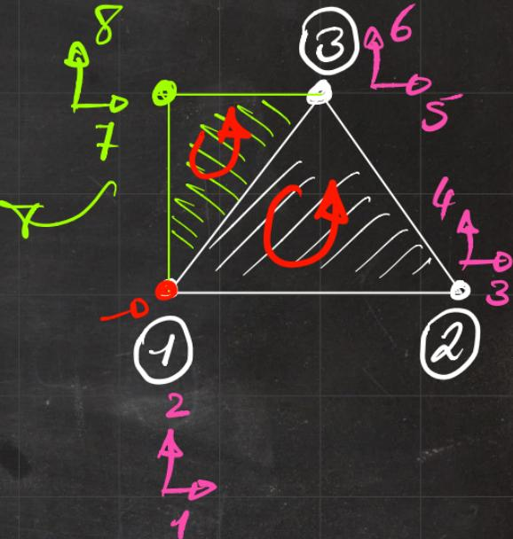
$$[K] = \frac{1}{\Delta} \begin{bmatrix} K_{11} & K_{12} & & & & \\ K_{21} & K_{22} & & & & \\ & & K_{33} & K_{34} & K_{35} & K_{36} \\ & & K_{43} & K_{44} & K_{45} & K_{46} \\ & & K_{53} & K_{54} & K_{55} & K_{56} \\ & & K_{63} & K_{64} & K_{65} & K_{66} \end{bmatrix}$$
